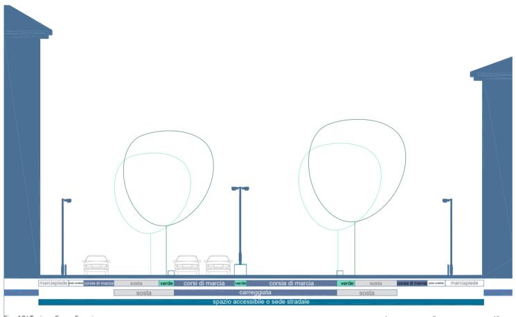
Fig. 18/ Torino, Corso Francia, sezione stradale, dove l'intero spazio accessibile è privo di dislivelli, I marciapiedi in prossimità dei fronti edilizi sono separati dalle corsie di marcia mediante la pista ciclabile. All'interno della sezione stradale sono stati inseriti anche degli elementi verdi che rendono il viale alberato molto piacevole.
