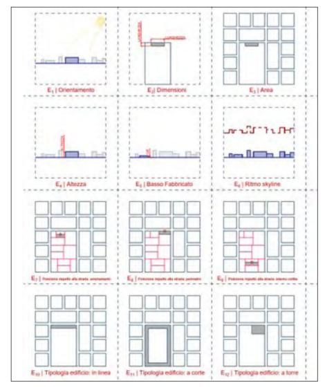
Fig. 42/ Parametri di valutazione relativi agli edifici: le caratteristiche geometriche, la forma, l'orientamento, la posizione rispetto allo spazio urbano e la relazione spaziale tra gli edifici.
