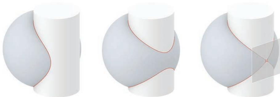
Fig. 8/ Curve del quart'ordine derivate dall'intersezione di due superfici quadriche, una quartica generica, una quartica digrammica e la finestra di Viviani.
