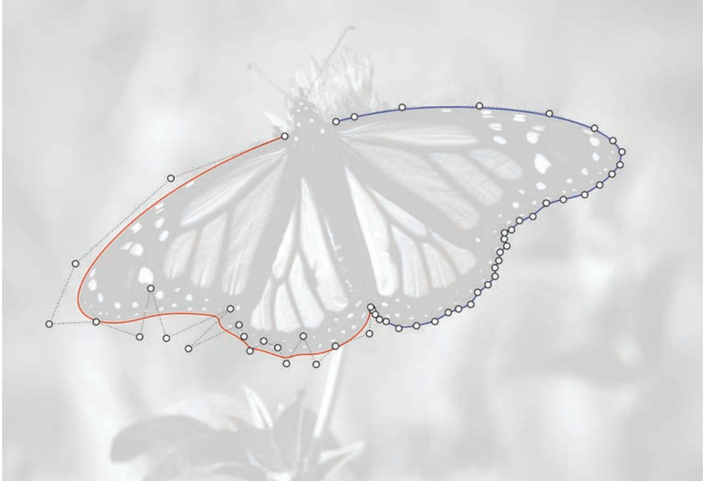
Fig. 11/ A parità di dettagli rappresentati una curva NURBS generata attraverso punti di controllo (in rosso) ha una geometria più semplice (21 punti di controllo) di una curva generata attraverso punti di interpolazione (in blu, 37 punti di controllo).
